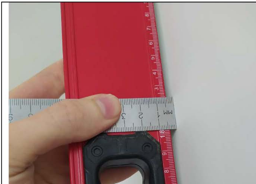
Фото №10. Измерение уровня стен в спальне.
