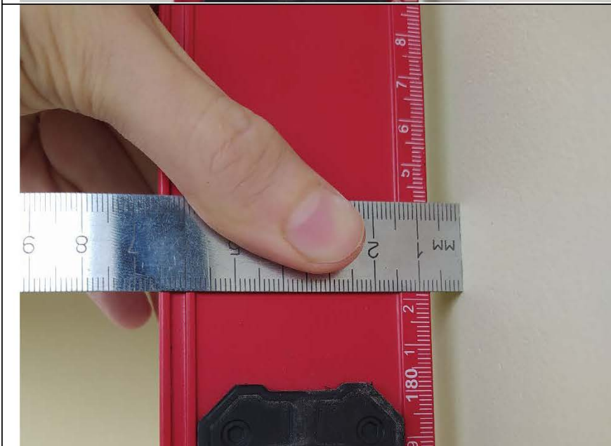
Фото №9. Измерение уровня стен на лоджии.
